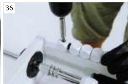
Beide Torzähler können mit Schrauben **L40mm** am Tischkorpus verschraubt werden. Dazu setzen Sie diese mittig zum Torkasten und mit Hilfe eines elektrischen Schraubendrehers fixieren Sie diese. Wiederholen Sie den gleichen Vorgang auf der anderen Seite.
