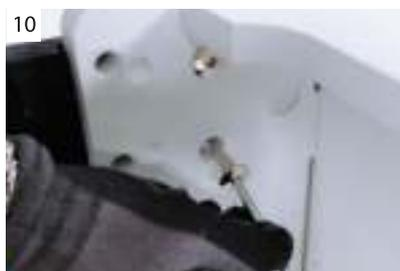
**(8)** Stellen Sie den Tischkorpus auf die Stirnseite und positionieren Sie zunächst die Tischbeine wie in Abb. **(9)**. Stecken Sie die Tischbeine in die dafür vorgesehenen Bohrungen und verschrauben auch diese lose händisch – nicht festziehen **(10)**.
